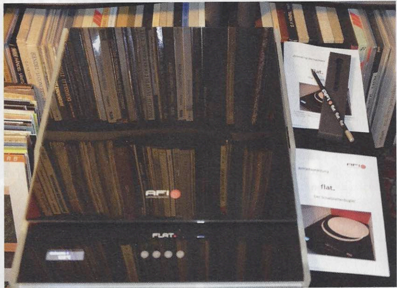
PLATTMACHER: Der Afi Flat erwärmt die LP perfekt gleichmäßig über Heizspiralen, die über Filzmatten nur indirekt aufs Vinyl einwirken. Auch stark verweilte Exemplare bekommt er wieder plan (oben links). Bedient wird das schwarzglänzend lackierte Gerät mit dem Magnetstift oben rechts.
